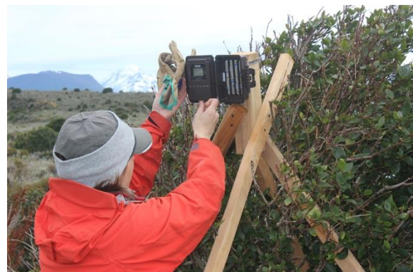
Figura 3: Una cámara de lapso de tiempo de marco RECONYX en Isla Martillo, Canal Beagle, Argentina.
